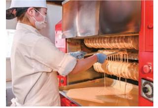
専用の器具で山を付けていく作業。火の強さや回転速度の調整など常に気が抜けません
